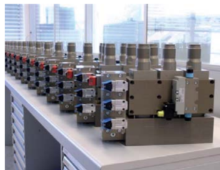
Ventilblöcke erhalten durch anodische Umwandlung der Oberflächen sowohl einen dauerhaften Schutz gegen Korrosion und Verschleißbeanspruchung, als auch hervorragende Gleiteigenschaften.
