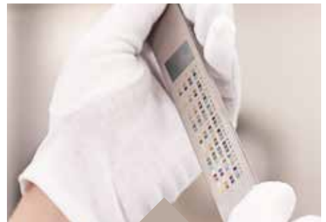
Mögliches Farbspektrum auf Titan für das Laserbeschriften mittels Anlassen
