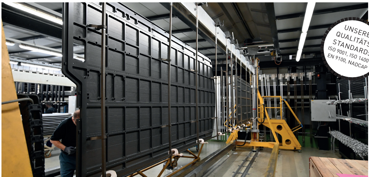
Harteloxieren in Übergrösse für die Luftfahrt mit Permalux-Harteloxal
