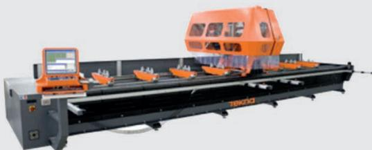
Centre d'usinage de profilés à 4 axes
